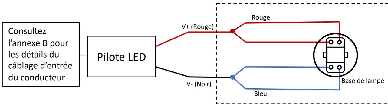
L'illustration dépeint les fils de luminaire existants et est pour référence seulement. Votre couleur de fil de luminaire, type de connexion et la quantité peut varier. COUVREZ INDIVIDUELLEMENT LES FILS NON UTILISÉS.
