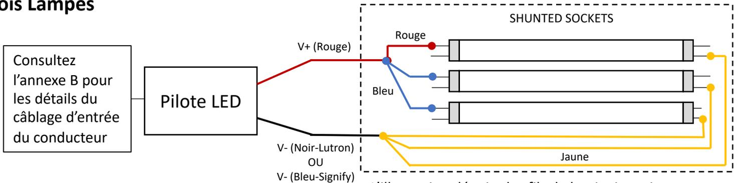
L'illustration dépeint les fils de luminaire existants et est pour référence seulement. Votre couleur de fil de luminaire, type de connexion et la quantité peut varier. COUVREZ INDIVIDUELLEMENT LES FILS NON UTILISÉS.
