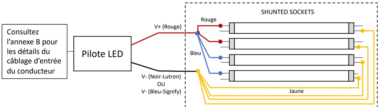
L'illustration dépeint les fils de luminaire existants et est pour référence seulement. Votre couleur de fil de luminaire, type de connexion et la quantité peut varier. COUVREZ INDIVIDUELLEMENT LES FILS NON UTILISÉS.
