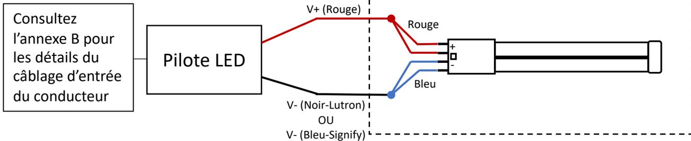
L'illustration dépeint les fils de luminaire existants et est pour référence seulement. Votre couleur de fil de luminaire, type de connexion et la quantité peut varier. COUVREZ INDIVIDUELLEMENT LES FILS NON UTILISÉS.
