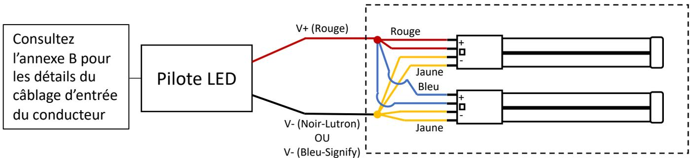
L'illustration dépeint les fils de luminaire existants et est pour référence seulement. Votre couleur de fil de luminaire, type de connexion et la quantité peut varier. COUVREZ INDIVIDUELLEMENT LES FILS NON UTILISÉS.
