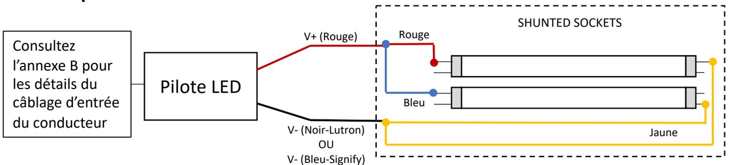
L'illustration dépeint les fils de luminaire existants et est pour référence seulement. Votre couleur de fil de luminaire, type de connexion et la quantité peut varier. COUVREZ INDIVIDUELLEMENT LES FILS NON UTILISÉS.
